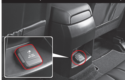
Onduleur AC (à l'arrière de la console centrale)
